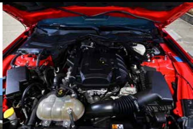
搭載されるエンジンは2.3ℓ直4エコブースト。最高出力314hp、最大トルク44.3kg・mを発生させ、マニュアルモード走行も可能なセレクトシフト付きの6速ATで操る。FR駆動初採用となったエコブースト搭載という点も特筆物だ。
