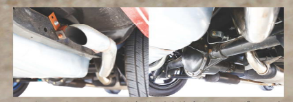
リアサスペンションはコイルリジッドのままだが、トレーリングアームをCCPの製品に変更。マフラーはシンプルだがフロントパイプから交換し、V8サウンドを奏でる。
