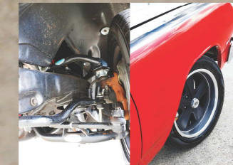
リアサスペンションはコイルリジッドのままだが、トレーリングアームをCCPの製品に変更。マフラーはシンプルだがフロントパイプから交換し、V8サウンドを奏でる。
