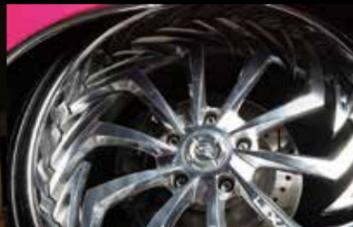
ホイールはLEXANI FORGEDのLC-777 JAGGモデル22インチ。フィニッシュはシンプルにポリッシュ。ブレーキはCPPのキャリパーとドリルド/スリットローターの組み合わせにアップデート。エアサスはワンボディのデジタルユニット「FREEAIR」をセット。メモリーもありながら必要最小限の機能を集約した先端モデルで、コントロールは専用リモコンでもスマホアプリどちらでも可能。
