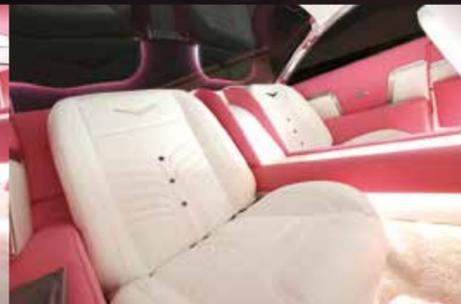
ストックのベンチシートをセパレート化は定石となっているが、最近ではアフターマーケットでも良質な汎用セパレートシートが複数存在する。その中でチョイスしたシートをベースに、内部のウレタンも調整、表皮のパターンもカスタムした上で張り替えられている。フルサイズのアメリカ車は意外と広くないものの、シートレールから座面までの全高をナローしたことで、より広い空間に感じられる室内。ドアパネルはベースの素材からすべてワンオフデザイン。センターコンソールも同様にワンオフで製作。昨今のトレンドを反映したインテリアを実現させている。
