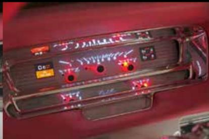
独特の形状をした1959年らしいダッシュパネル形状はそのまま生かしてレザー張りとしている。こだわりのインテリアの中でも、特にゲージはメーカーラインアップには存在しないDakota Digital製の最新HDXをストックのベゼルをベースに特注で製作してセット。ストックのデザインをトレースしながらも、2つのマルチインフォメーションスクリーン、シフトポジション、時計など様々なインフォメーションの正確な表示が可能になっている。デジタルコントロールメーターへの換装は、機能面だけではなく、ルックスも格段にアップ。ヘッドユニットはクラシカルなデザインのBluetooth対応モデルを装着し、使い勝手も現代のシステム同様。
